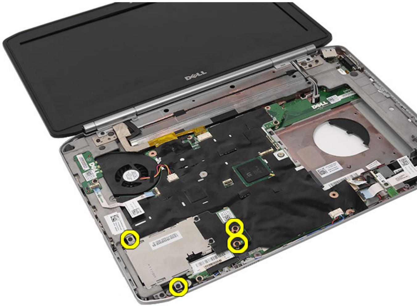
10. Trennen Sie die Abschirmung vom Systemplattenanschluss.
