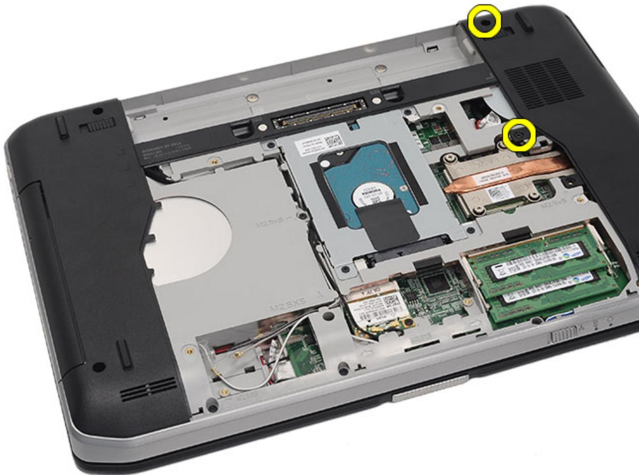
5. Entfernen Sie die CPU-Klappe.
