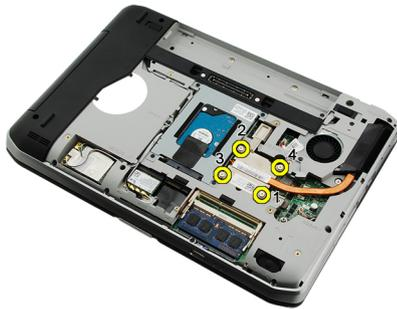
6. Heben Sie den Kühlkörper an und entfernen Sie ihn aus dem Computer.
