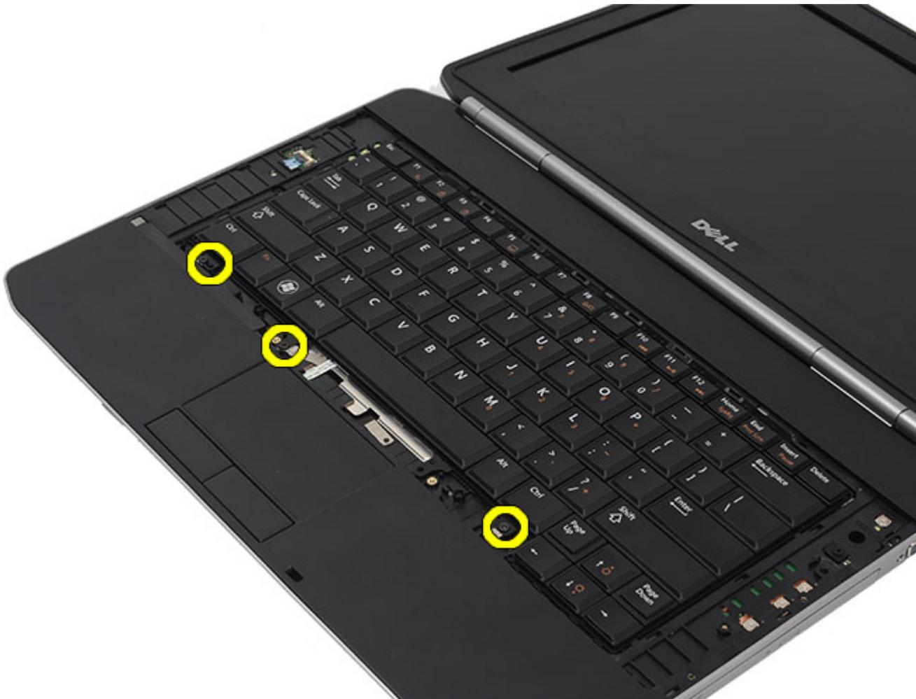
5. Drehen Sie den Computer um und entfernen Sie die Schrauben, mit denen die Tastatur am Computer befestigt ist.
