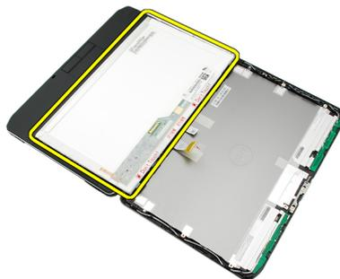
7. Entfernen Sie die Schrauben, mit denen die Bildschirmhalterungen am Bildschirm befestigt sind und entfernen Sie die Halterungen.
