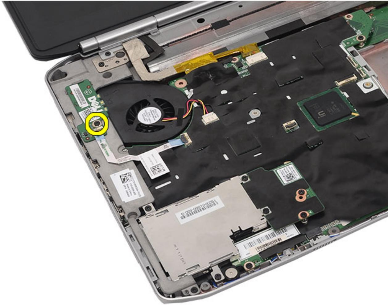
10. Trennen Sie das LED-Platinenkabel vom Systemplatinenanschluss.
