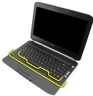
4. Hebeln Sie das Tastaturgehäuse an der Oberkante nach oben.
