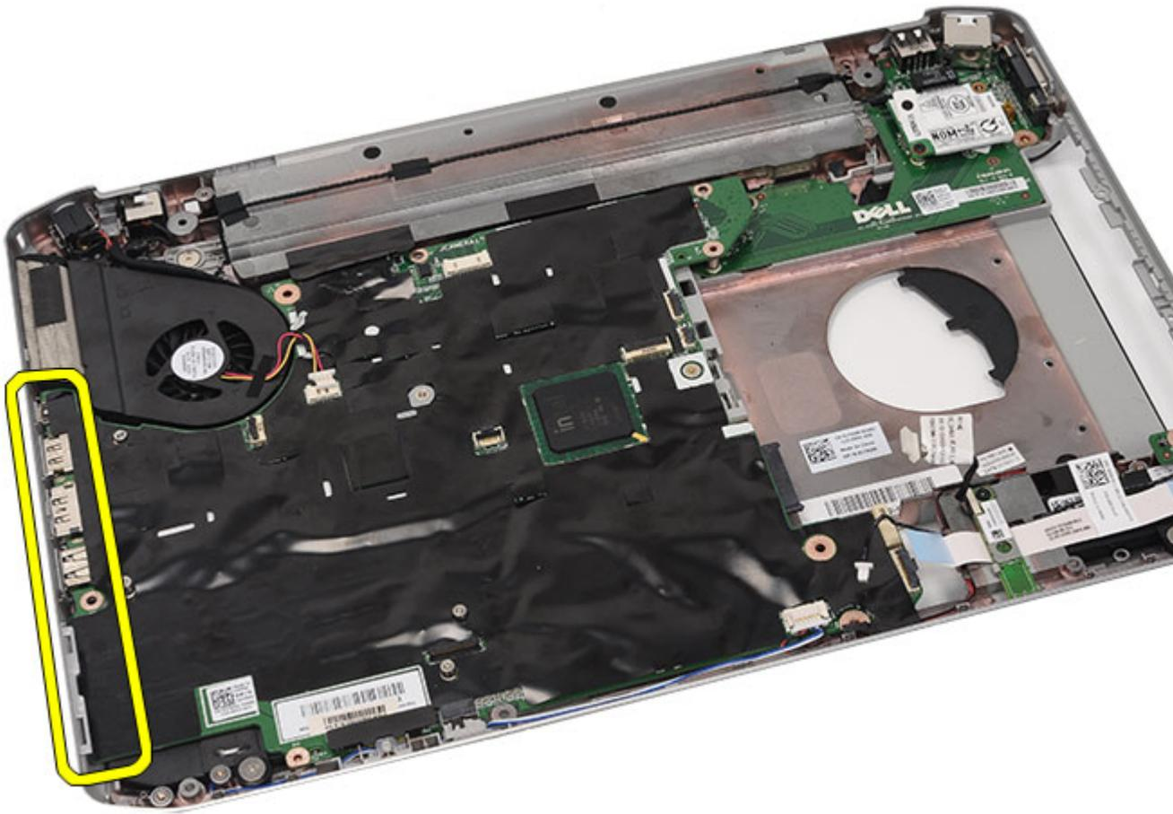
26. Entfernen Sie die Systemplatine.
