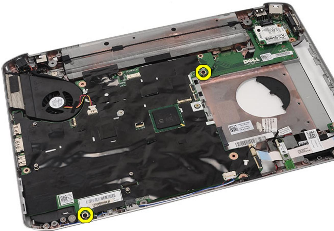
24. Heben Sie die Kante der Systemplatine an, um sie von der Eingabe/Ausgabe (E/A)-Leiste zu trennen.
