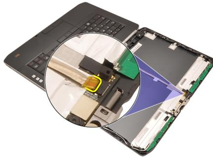
6. Lösen Sie die Sicherungsschraube des Kameramoduls.
