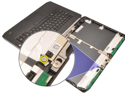
7. Heben Sie das Kameramodul an, und entfernen Sie es.
